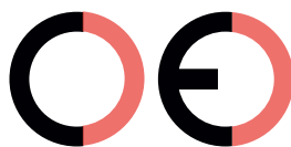
Marca CE falsa (demasiado separados)
